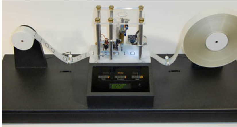
Figura 2: Modello fisico di macchina di Turing. Immagine tratta dal sito A Turing Machine .
